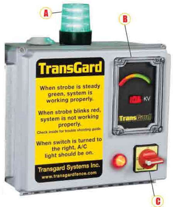
A. Alert strobe B. Digital volt meter C. On/off switch
